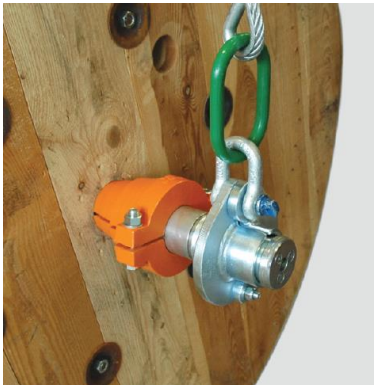
Exemple pour la suspension sur l'arbre avec cône de centrage ; sté. Vetter
