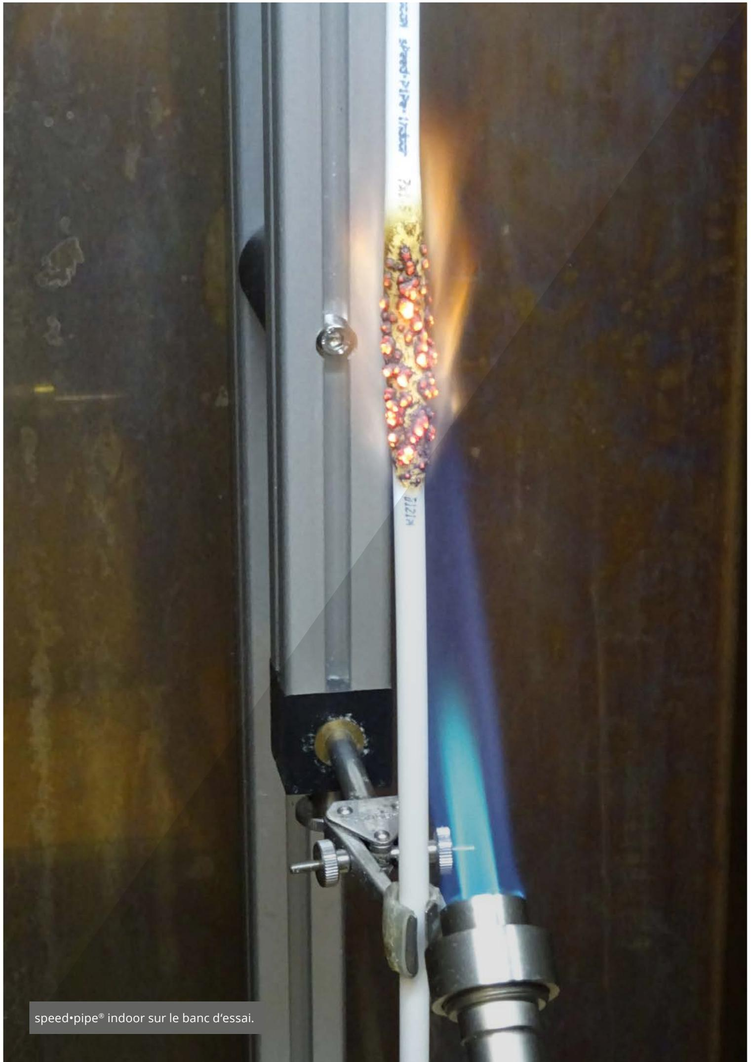
speed•pipe® indoor sur le banc d'essai.
